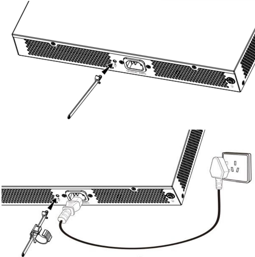
图 14 连接电源线防跳闸（可选）
