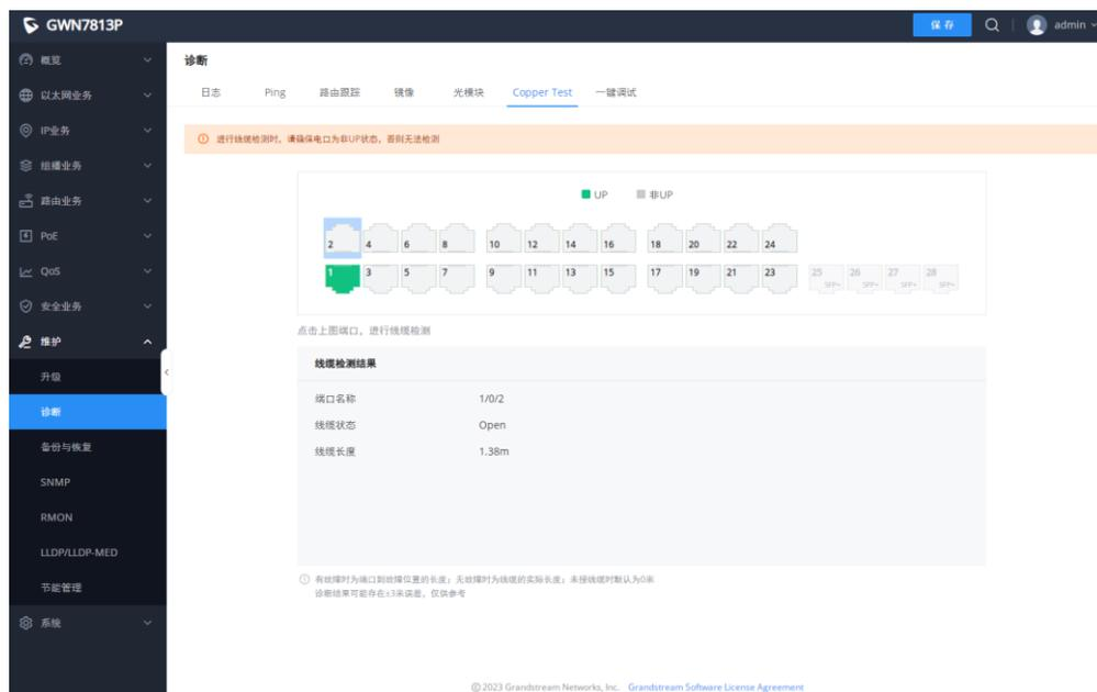
图 127 诊断-线缆检测
