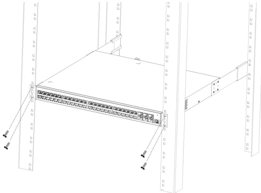
图 11 GWN7816P 安装在机柜中
