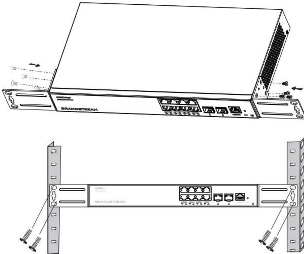
图 8 GWN7811(P)-GWN7812P-GWN7813(P)-GWN7816 机架安装
