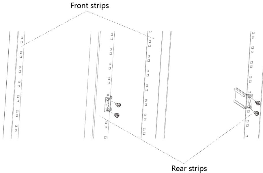
图 10 安装后挂耳支架
