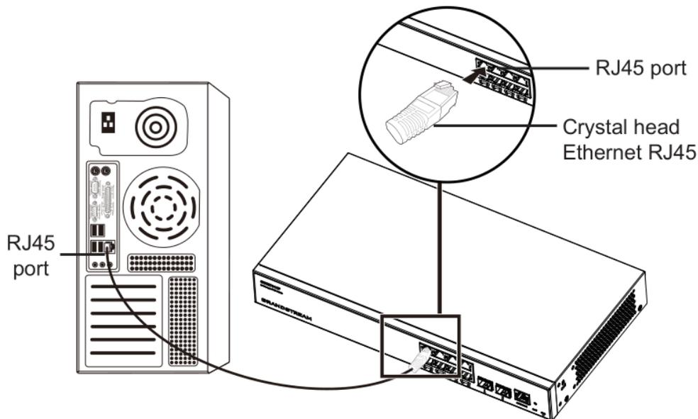
图 17 连接 RJ45 接口
